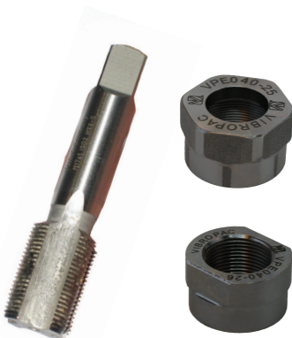
Reinigingsset voor verstuiverboringen Incl. nabewerking verstuiverzitting
